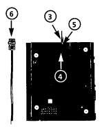
Das Anschlusskabel (3) auf der Unterseite der Basisstation in die mit einem «Telefon» gekennzeichnete Buchse (4) einstecken. Kabel durch den Kanal führen (5). Den Stecker (6) in Ihre Telefon-Dose einstecken. Falls der Stecker nicht passt, benötigen Sie einen Adapter (im Telecom Shop oder bei Ihrem PTT-Fachhändler erhältlich).
