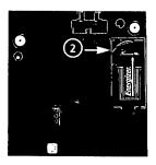
9-Volt-Batterie an den Batteriestecker (2) anschliessen und in das Batteriefach einlegen.
