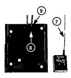
Das Netzteilkabel (7) auf der Unterseite der Basisstation in die mit einem «Netzteil» gekennzeichnete Buchse (8) einstecken. Kabel durch den Kanal führen (9). Den Netzteilstecker in eine 220/230-Volt-Steckdose einstecken.
