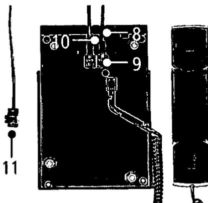
Das Anschlusskabel (8) auf der Unterseite des Apparates einstecken (9) und durch den Kanal führen (10).
