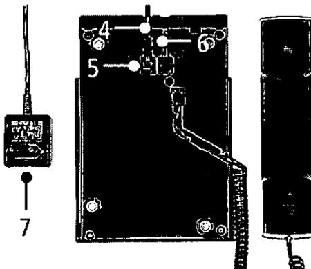
Das Netzkabel (4) auf der Unterseite des Apparates einstecken (5) und durch den Kanal führen (6). Den Netzstecker (7) in die Steckdose einstecken (benutzen Sie auf jeden Fall das mitgelieferte Netzteil). Die LED-Anzeige blinkt für kurze Zeit. Vermeiden Sie während dieser Aufstartzeit jede andere Bedienung.
