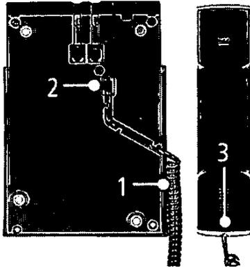
Das spiralförmige Hörekabel (1) auf der Unterseite des Apparates einstecken (2), durch den Kanal führen und am Hörer (3) einstecken.
